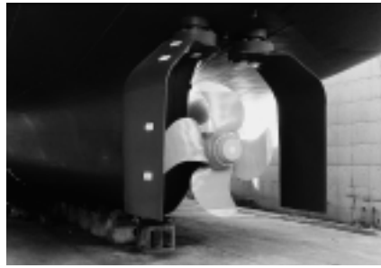
プロペラの両側に配置する新発想のゲートラダー
