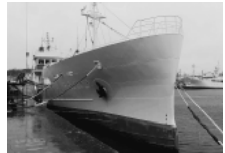
垂直な先端部のTM-フィッシャーバウ
